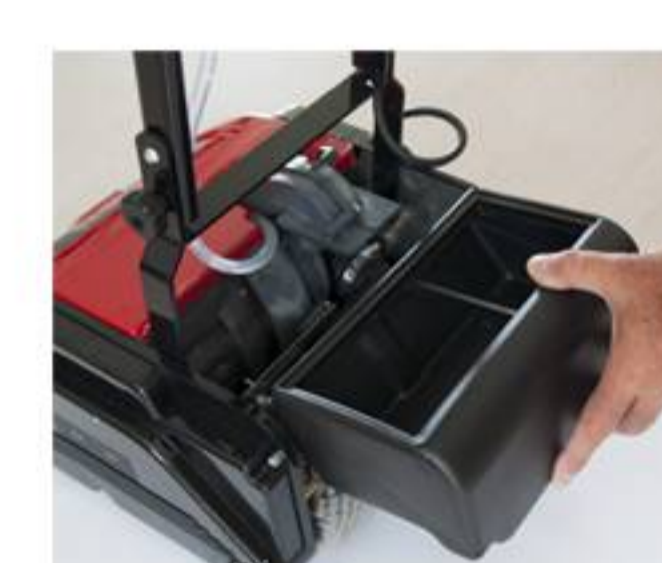
serbatoio recupero estraibile Lt 3
